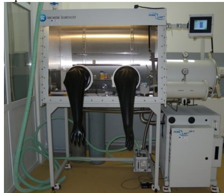
Sistem PureLab HE 2GB" boxa cu mănuși cu atmosferă controlată
