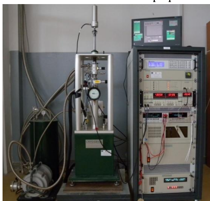
Sistem 7T Mini Cryogen He Free pentru caracterizarea proprietăților magnetice, electrice și termice
